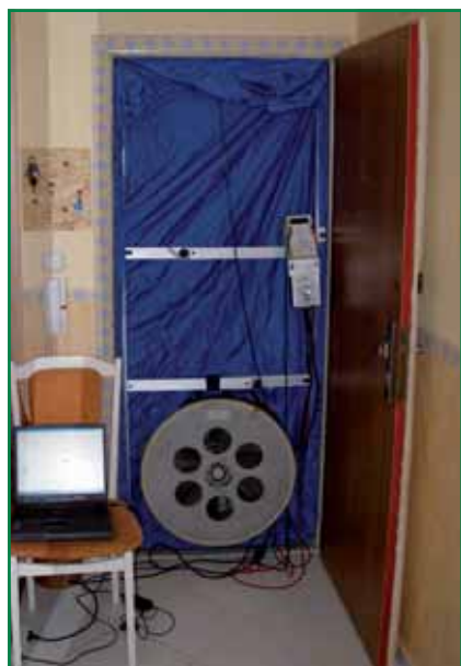
Obr. 21: Zariadenie pre Blower-Door test sa skladá z teleskopického rámu, vzduchotesnej plachty, ventilátora a riadiacej jednotky
